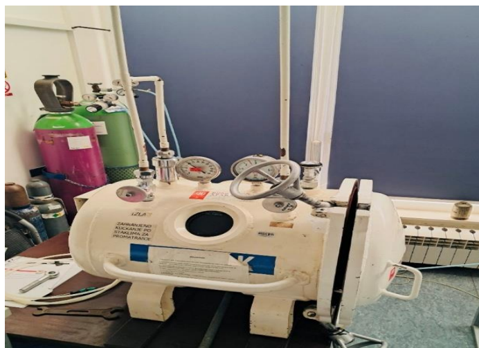
Slika 4.2.2. Hiperbarična eksperimentalna komora za laboratorijske životinje (Izvor: autor rada)
