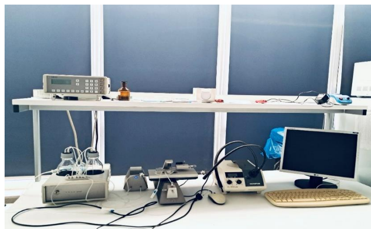
Slika 4.2.3. Tlačni miograf povezan s računalom
