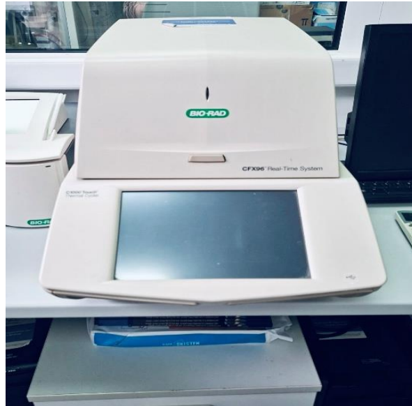
Slika 4.3.7.1. Bio-Rad CFX96 Real-Time PCR sustav korišten u ovom istraživanju za kvantitativno određivanje izražaja ciljnih gena metodom qPCR.
