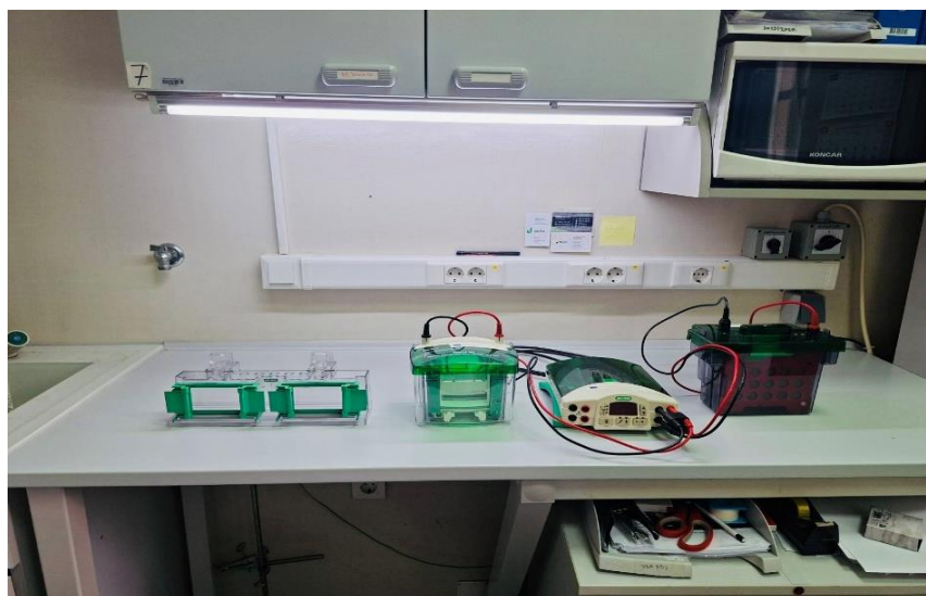
Slika 4.3.8.1. Sustav za Western blot analizu prikazan s lijeva na desno: (1) aparat za izljevanje poliakrilamidnih gelova korišten za pripremu razdvajajućih i koncentrirajućih gelova prema veličini proteina, (2) kadica za SDS–PAGE elektroferazu u kojoj se provodi razdvajanje proteina prema molekularnoj masi pod denaturirajućim uvjetima, (3) izvor napajanja (engl.
